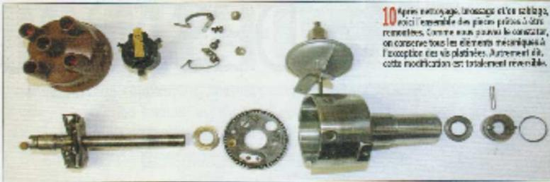
**10** Après nettoyage, brossage et séchage, voici l'ensemble des pièces prêtes à être remontées. Comme nous avons le contact, on conserve tous les éléments mécaniques à l'exception des vis plastifiées. Attention cependant à cette modification en traitement réversible.
