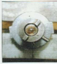
**13** Mettre en place la ou les coques trouvées au démontage, puis la tige d'entraînement et son plan d'accouplement. Ensuite le clip de maintien.
