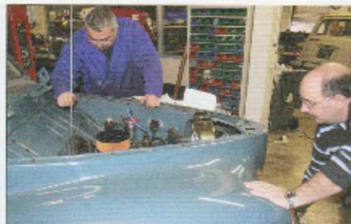
**30** Tourner le moteur dans le sens des aiguilles d'une montre jusqu'à mettre en explosion la quatrième cylindrée (quatrième cylindre en bas de la culasse).
