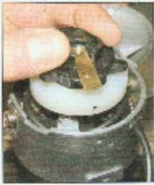
**20** Vérifier que la diode pose entre 1 et 3 mm audessus du bouton du capteur.
