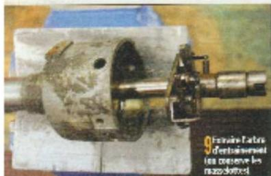
**9** Enlever l'arbre d'entraînement des rotors et les vis à desserter.
