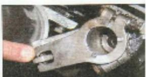
**11** Dans cette position, nettoyez et placez le levier de commande d'accélérateur, roulette de réglage centrée.
