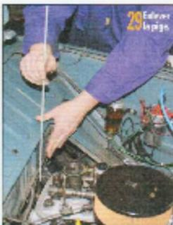
**29** Insérer la pique dans le moteur jusqu'à ce qu'elle pénètre dans son encreux. Le temps doit s'allonger. Si nécessaire, dégager la pique et faire un tour de déboulon pour mettre le premier cylindre en explosion (quatrième cylindre au bas de la culasse).
