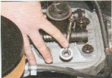
**8** Déposez le carter carburetor et, en faisant tourner le moteur dans le sens des aiguilles d'une montre, mette les soupapes du quatre cylindres le plus près de la pompe à eau en bas : ils dépasseront l'échappement.
