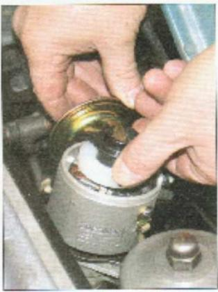
**12** Inversez l'allumeur, faitz orienter vers le premier cylindre. La tige d'orbiteur devrait ainsi se trouver face à la fenêtre du doigt d'arrachement.
