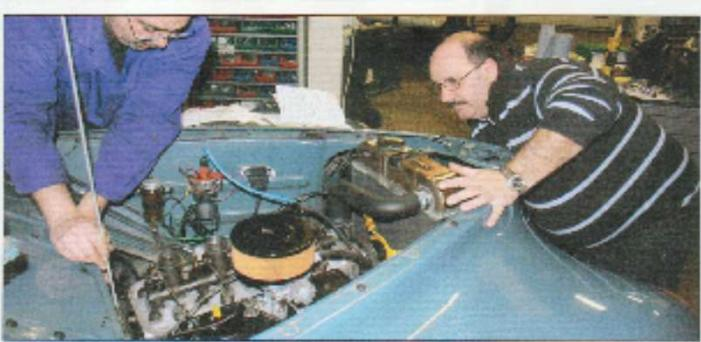
**31** Insérer la pique et continuer à tourner très lentement jusqu'à ce qu'elle pénètre dans son encreux. Le temps doit s'allonger. Si nécessaire, dégager la pique et faire un tour de déboulon pour mettre le premier cylindre en explosion (quatrième cylindre au bas de la culasse).
