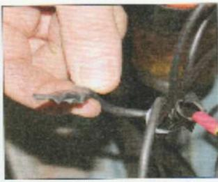
**7** La cannette d'origine du rupteur se fait par le connecteur entre la bobine et l'allumeur. Nous l'avons simplement isolé. Si nous devons un jour passer à un allumage électronique, il suffit de débrancher le rupteur et de connecter la fil au rupteur. Ça prend deux secondes.
