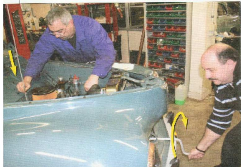
**10** Faire tourner le moteur dans le sens des aiguilles d'une montre jusqu'à ce que la pince s'enfonce dans l'écoude pivotante à cet effet. Si tout a bien été réglé (position du bout d'argot centrallement à l'allumeur - voir Montage initial, sect. en 14, Géométrie de l'allumage), il suffit d'un simple coup de poignard pour y parvenir.
